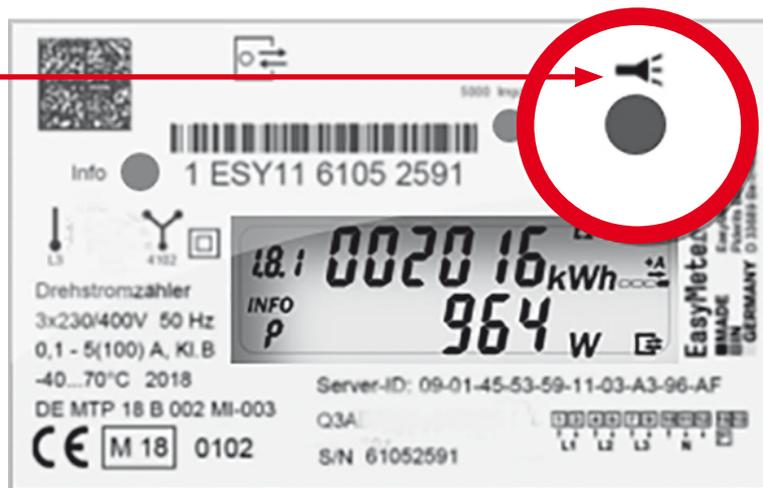
Ihre neue Messeinrichtung ist mit einem sogenannten „optischen Taster“ ausgestattet. Dies ist eine Fotodiode, die einen mechanischen Taster ersetzt. So kann die Messeinrichtung auch bedient werden, wenn diese zum Beispiel hinter Glas ist. Der optische Taster funktioniert beispielsweise durch den Lichtimpuls einer Taschenlampe.
